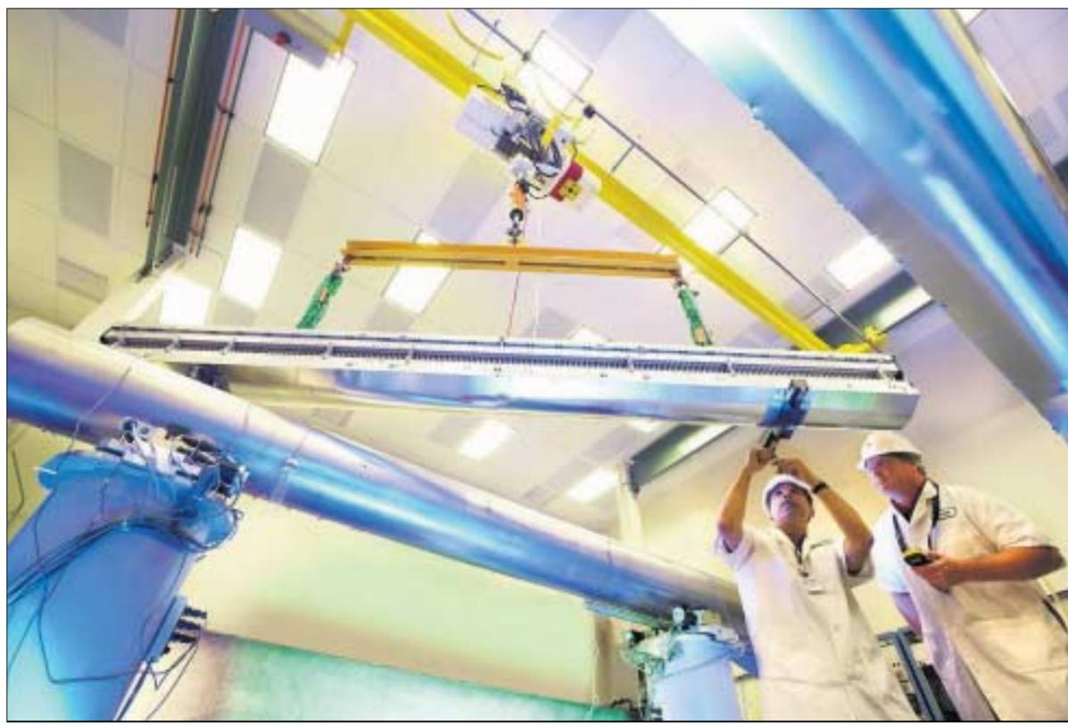
**Oben: Ingenieure beim Installieren der Magnete des Röntgenlasers LCLS in Stanford, Kalifornien. Der Röntgenlaser wird holografische 3-D-Bilder von einzelnen Molekülen liefern. Links: Modell zum Injizieren einzelner Moleküle in den Laserstrahl.**
